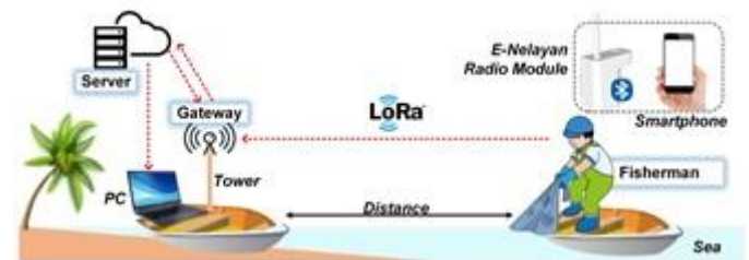
Fig. 11. Field test scenario
